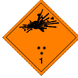
(No. 1) Tehlike Bölümleri 1.1, 1.2 ve 1.3 Sembol (patlayan bomba): siyah; Zemin: turuncu; Alt köşede "1" rakamı
